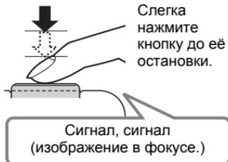
При нажатии кнопки спуска затвора до половины камера автоматически регулирует экспозицию и фокусируется на объекте, на который она направлена. Освоение необходимой силы нажатия кнопки спуска затвора до половины и полностью является важным навыком, позволяющим создавать хорошие изображения.
