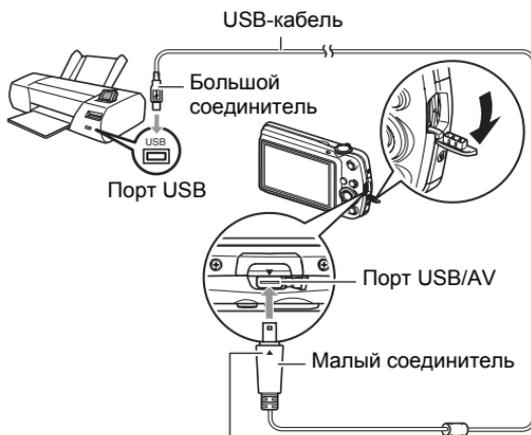
Убедившись в том, что пометка ▼ на камере соответствует расположению пометки ▲ на соединителе USB-кабеля, подключите кабель к камере.
