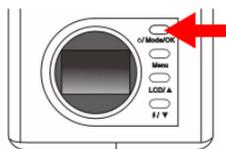
Для выключения питания камеры удерживайте нажатой кнопку Power/Mode в течение 2 секунд. Изображение на экране ЖК-дисплея исчезает. Затем происходит выключение питания.
