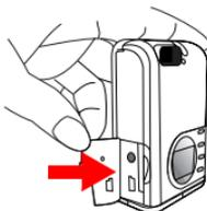
После открытия крышки открывается доступ к порту USB, который обозначен с помощью стрелки.
