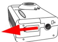
Нажмите на крышку батарейного отсека и сдвиньте ее в указанном направлении.
