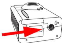
Закройте крышку батарейного отсека и сдвиньте ее в указанном направлении.
