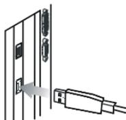
Второй конец кабеля USB подключите к порту USB на задней панели компьютера, при этом питание камеры DC 1500 будет осуществляться от персонального компьютера.
