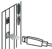
Второй конец кабеля USB подключите к порту USB на задней панели компьютера, после чего компьютер автоматически произведет установку DC 1500 в системе в качестве нового дисковода.
